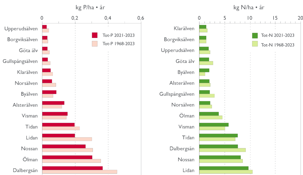
Figur 4. Areal specifika förluster av fosfor och kväve uttryckt som medelvärden för perioden 2021–2023, samt för hela perioden 1968–2023. Anmärkning: Kväveförlusterna baseras delvis på resultat från olika analysmetoder.
