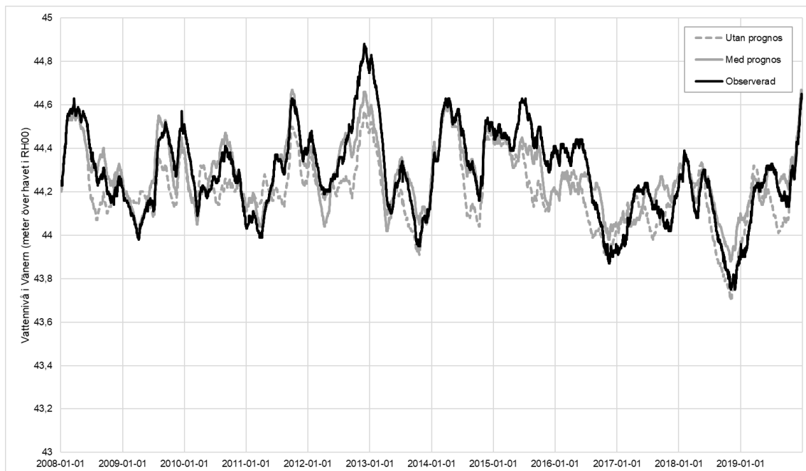
Figur 4. Jämförelse mellan observerad vattennivå samt beräknad vattennivå enligt nuvarande strategi med och utan hänsyn till prognos 8 veckor. Figuren visar en tidsserie från 2008 till 2019. Den höga observerade vattennivån under 2012 och 2013 är påverkad av en långvarig låg tappning på grund av underhållsarbete.
